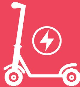
Personal Mobility Vehicles (oder PMVs, einschließlich Elektroroller) sind ein- oder mehrrädige Fahrzeuge mit einem Sitz und ausschließlichem Elektromotorantrieb mit einer bauartbedingten Höchstgeschwindigkeit zwischen 6 und 25 km/h.
